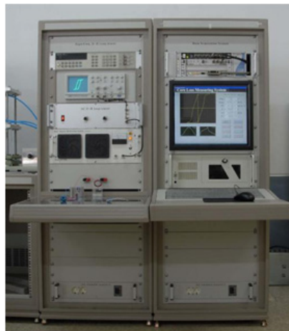
그림 2. 고주파 AC B-H loop 측정장치
