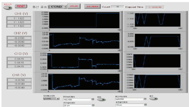
그림 6 . LabVIEW를 통한 4-channel Hall effect gaussmeter의 구현.
