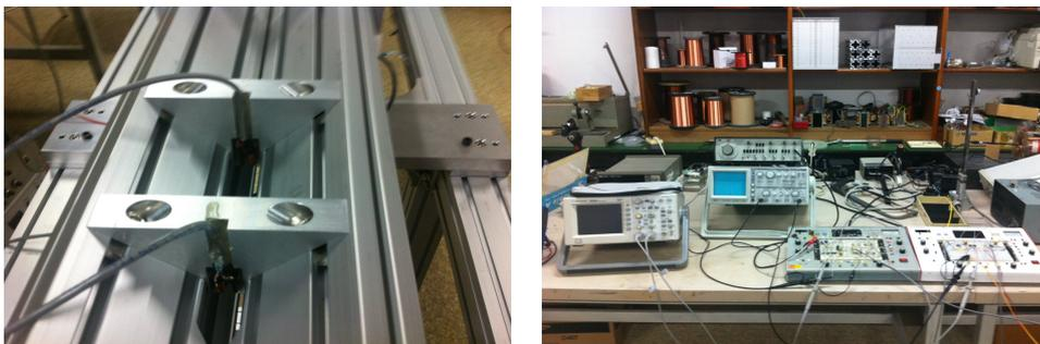
그림 1. 모의탄 발사장치에 부착된 U자형 와전류 탐촉자 (a) 및 측정장치 (b).
