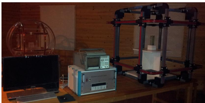
그림 1. 직류 자기센서 시험 장치
