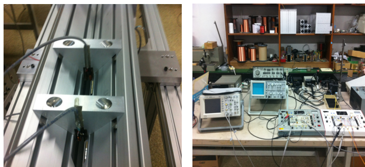
그림 1. 모의탄 발사장치에 부착된 U자형 와전류 탐촉자(a) 및 측정장치(b)
