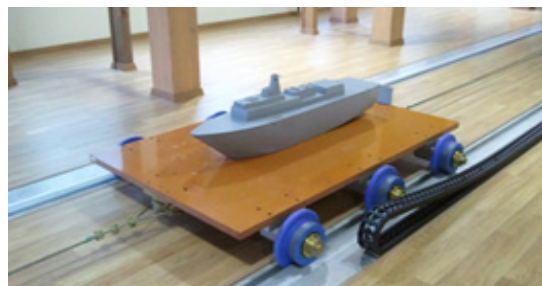
그림 1. 축소함 내부에 설치된 소자코일 배치 그림 2. 비자성실험실에서의 축소함 자기장 측정 장면
