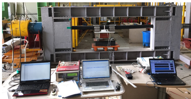
그림 2. 텐던에 인장변형력을 인가하는 장치에 부착된 장치의 사진.
