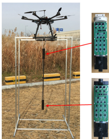
그림 1. 본 연구에서 제작한 3-축 flux-gate magnetometer 2개를 사용한 gradiometer
