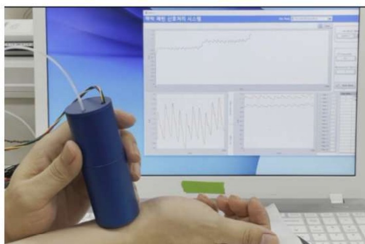
그림 1. 자성기반 펜슬형 맥박 패턴 실시간 측정 시스템
